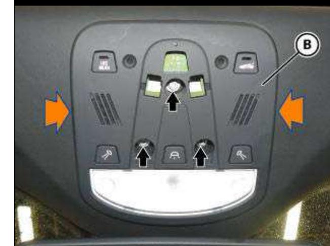
● 松开指示的紧固座舱灯 (B) 的三个螺钉。
